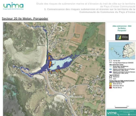
Figure 33 : Enjeux bâtis exposés à la submersion sur le secteur 20 Ile Melon (Porspoder)
